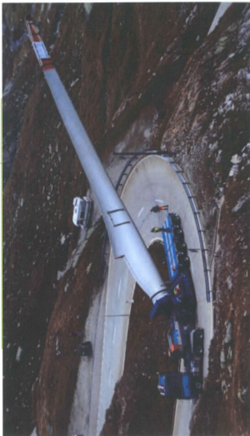
Photographie 17. Transport d'une pale sur châssis alpin
