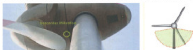
Figure 44. Microphone de type Batcorder installé sur une nacelle (Source : http://www.nhbs.com/batcorder_wind_turbine_extension_tefno_177246.html )
