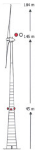
Photographie 14. Balise d'une éolienne E-126 sur le site d'Estinnes en Belgique
