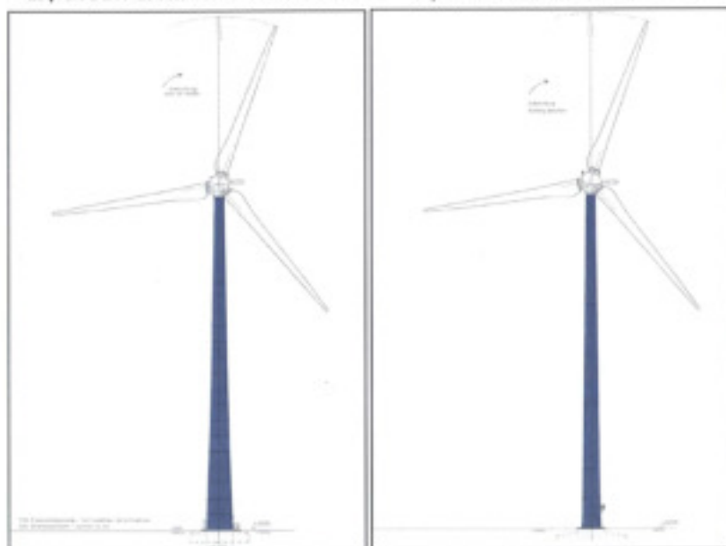
Figure 55. Différence mât acier / mât béton
